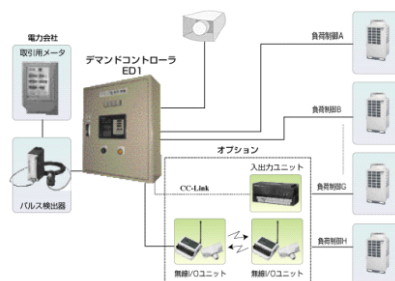
デマンドコントローラー 出所: 設備メーカーHP
