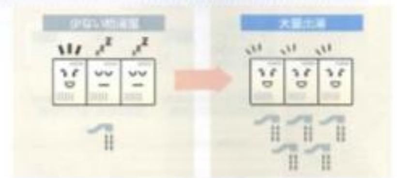
使用する湯量に応じて燃焼、給湯する台数が増減します。（貯湯槽併用の場合は、異なります）
