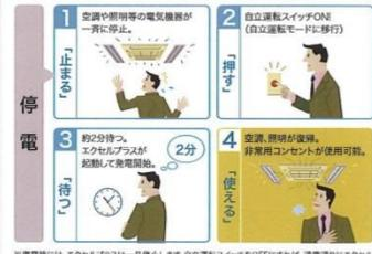
※復電時には、エクセルプラスは一旦停止します。自立運転スイッチをOFFにすれば、通常通りにエクセルプラスが使用できます。
