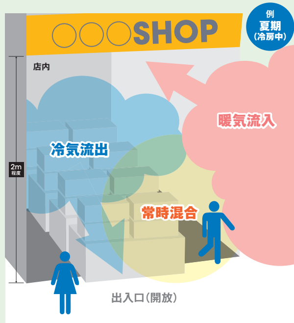
図Ⅲ-3-5 出入口の空調エネルギーロスのイメージ
