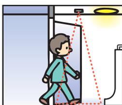
人が検知範囲に入ると、人の動きを検知して照明を自動点灯します。
