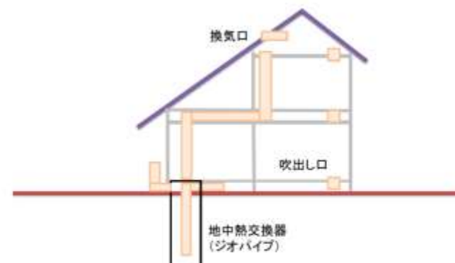
地中熱利用システム 空気循環方式
