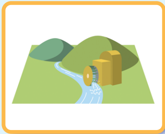
小水力発電 (単機出力1~1000kW以下)
