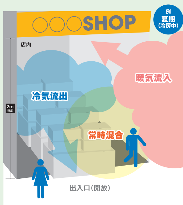
図Ⅲ-3-6 出入口の空調エネルギーロスのイメージ
